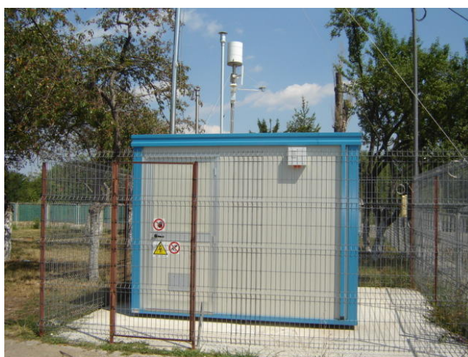
Figura 57 – Stație de monitorizare automată a calității aerului
